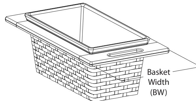
**3)** *Resta la medida obtenida del BW de la medida ICW. Divida el resultado entre 2. Reste 1/16" de la respuesta. Esto le dará la dimensión que se necesita desde la parte inferior de la ranura hacia la parte posterior del riel de madera.*
