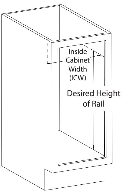
Mesurez la largeur à l'intérieur de l'armoire (ICW) à la hauteur désirée pour les rails en bois.
