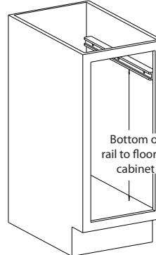
**8)** *Instale el segundo riel en el lado opuesto del gabinete por los pasos 5 y 6 a la ubicación de la altura del paso 7.*
