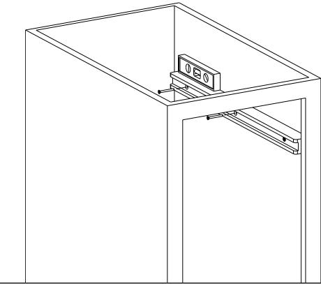
**7)** *Mida desde la parte inferior del gabinete a la parte inferior del riel instalado.*
