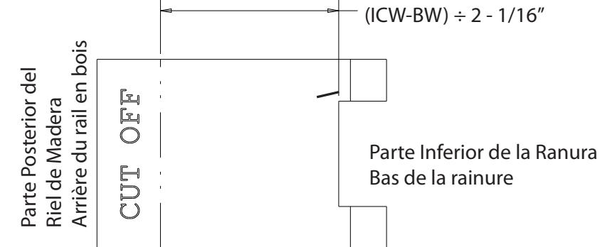
**5)** *Coloque el primer riel cortado, en el gabinete con el frente del riel en contra de la parte posterior del marco a la altura deseada (para gabinetes sin marco, alinee con el frente del gabinete). Asegure el orificio frontal con el tornillo del tamaño adecuado. (No se incluyen los tornillos, debido a la variante en el grosor de la pared del gabinete) (Asegúrese de que los tornillos no vayan a atravesar la pared exterior del gabinete).*
